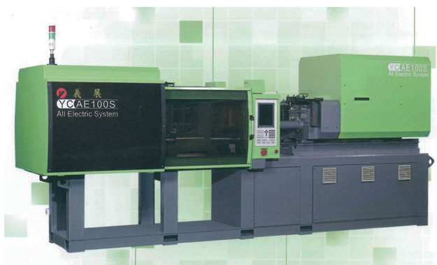
義展全電式射出機是全機以電動伺服馬達直接驅動，不需經過油壓再轉換成動力驅動，較傳統油壓式射出機節省六至七成的電力消耗。（圖片提供／義展機械）
